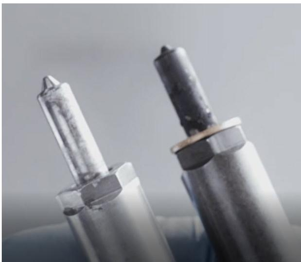
Détail des dépôts moteurs sur la base d'un injecteur
