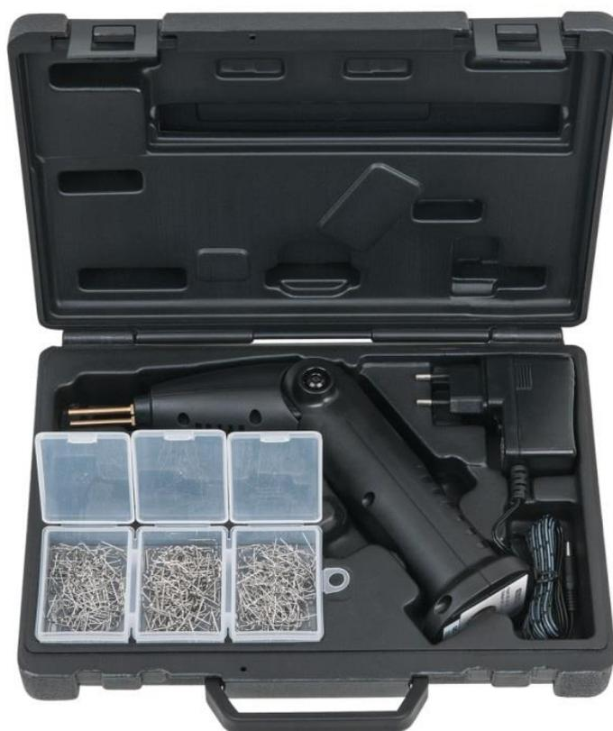
Ce kit est adapté pour les pièces avec un maximum de 40% de fibre de verre et fonctionne sur batterie. Il peut également être branché directement sur le secteur. Ce coffret est livré avec des agrafes de réparation en inox de diamètre 0,6 et 0,8 mm. Ces dernières sont insérées dans la matière au niveau des fissures et permettent de redonner de la stabilité à la pièce. *Attention, ce produit ne convient pas à la fibre de verre époxy et la fibre de carbone.*
