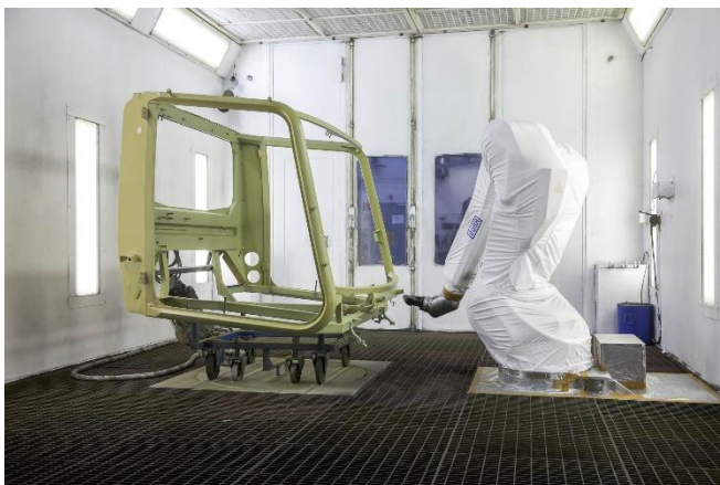
Le robot EcoRP L033 de Dürr EcoRP permet l'automatisation de l'application peinture chez Kässbohrer Geländefahrzeug AG.
