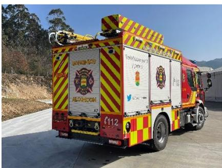
Le véhicule a une capacité d'eau de 3 500 litres et une capacité de mousse de plus de 100 litres. Sa largeur de caisse de 2 400 mm en fait le véhicule le plus étroit du marché, améliorant grandement l'accessibilité en milieu urbain et lui conférant un avantage concurrentiel significatif. Le camion est équipé d'une transmission 3200 entièrement automatique de la série Allison 3000™ et dispose d'un ralentisseur intégré pour un freinage amélioré et une usure réduite des freins.
