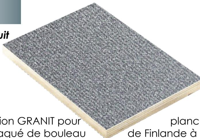
La nouvelle finition GRANIT pour plancher antidérapant est un contreplaqué de bouleau de Finlande à plis croisés de 1.4 mm avec un collage de classe 3 et recouvert d'un revêtement décoratif spécial. Sa surface filmé est dure et résistante à l'abrasion, à l'humidité et tolère les produits chimiques habituels, ainsi que les acides et alcalins dilués (détergents).
