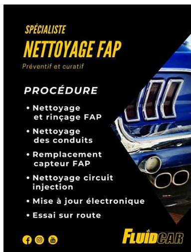
Le filtre à particule (FAP) fonctionne comme un piège. Lorsqu'il atteint un certain niveau de stockage des émissions nocives, un procédé chimique pyrotechnique (avec l'aide de cérine) le fait monter à très haute température, et brûle les suies stockées dans le FAP. Cette procédure se nomme la régénération.
