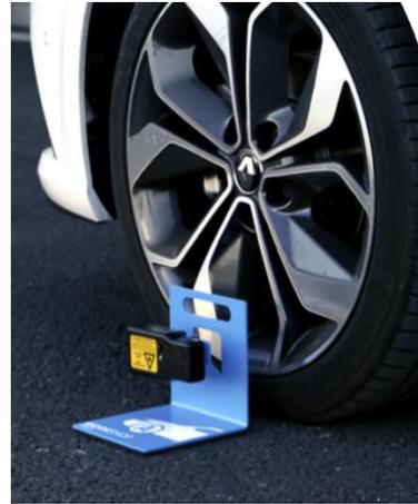
*Le dispositif laser inédit de compensation des irrégularités du sol permet une utilisation dans tous types d'ateliers.*
