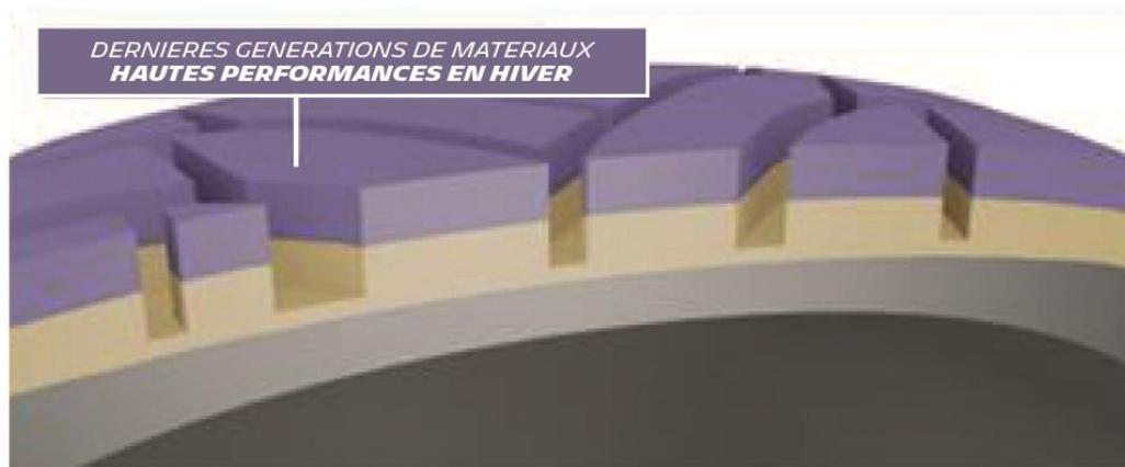
A un certain niveau d'usure, le mélange de bande de roulement change pour un mélange d'élastomères fonctionnels spécialement conçus pour apporter de la souplesse à la bande de roulement et améliorer l'adhérence en hiver sur la neige. Cette combinaison de ces bandes de roulement multicouches et cette bande de roulement qui évolue et se régénère, offre une adhérence inégalée tout au long de la vie du pneu jusqu'à l'usure avec une durée de vie supérieure de 20% / la moyenne des pneus concurrents.
