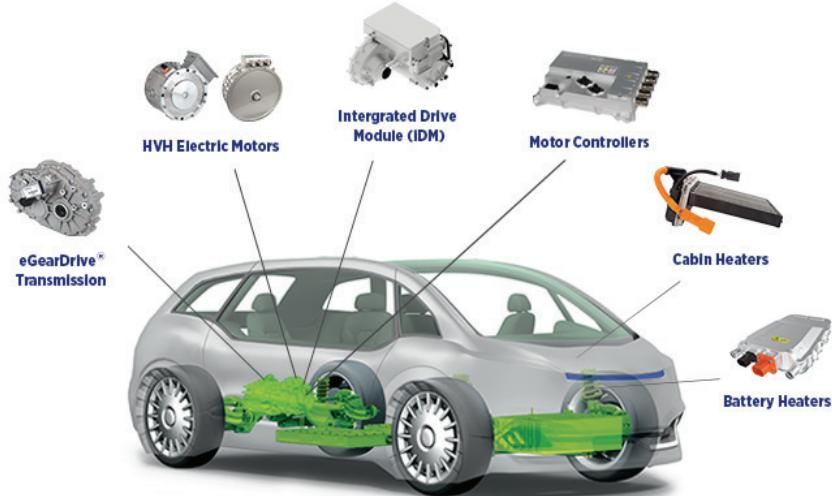
BorgWarner fournit des options flexibles et économiques pour assurer la propulsion des véhicules hybrides et électriques, sur la base de composants individuels ou de solutions systèmes pleinement intégrées.
