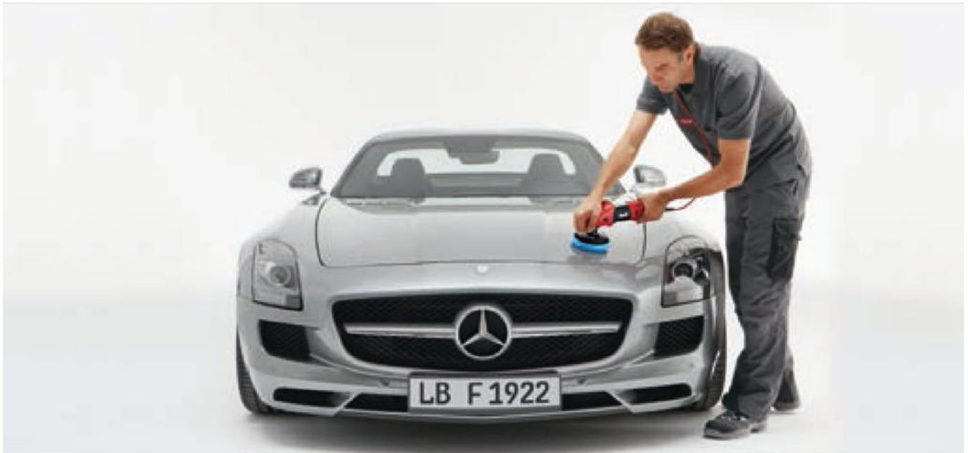
Pour un résultat optimal, l'interaction de la machine et de l'enduit, voire des éponges ou de la peau, est extrêmement importante. Il convient d'utiliser le bon accessoire en fonction des dommages subis par la peinture (éraflure, hologramme, etc.). Il est possible d'éliminer les éraflures à l'aide de l'éponge bleue et du produit de polissage FLEX.
