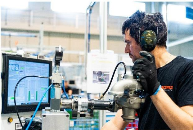
Photo 1 : Chaque turbocompresseur reconditionné subit plus de 30 tests pour répondre aux normes de qualité élevées de BORG Automotive Reman.
