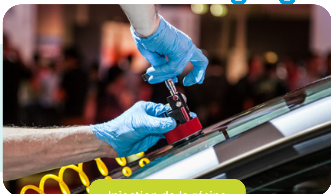
Injection de la résine
