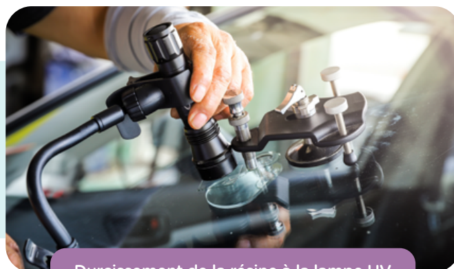
Durcissement de la résine à la lampe UV
