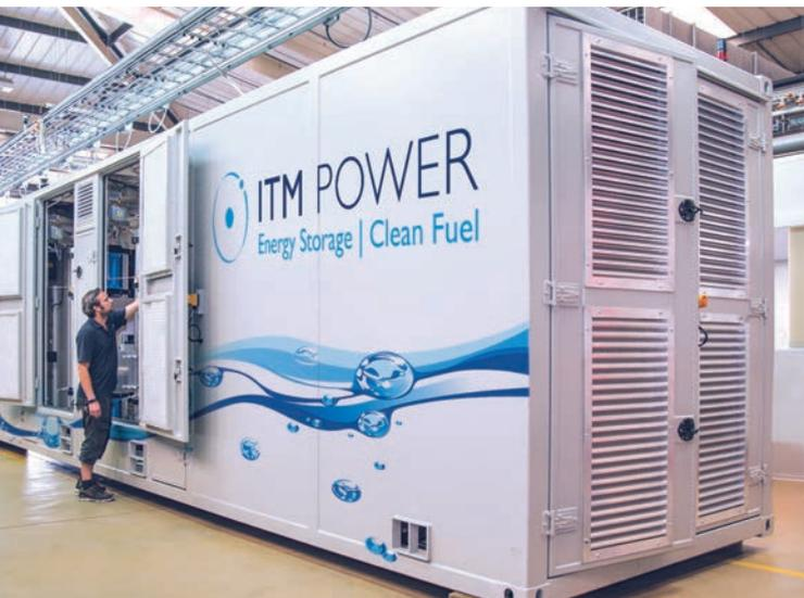
*Electrolyseur PEM intégré à une station hydrogène*
