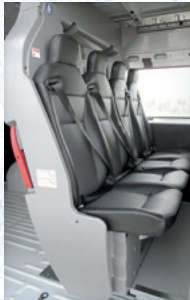
**Repliable** : deux véhicules en un. Ensemble coulissant, simple et pratique permettant de passer de 2/3 places cabine à 5/7 places. Sécurité, rentabilité et praticité optimisées.
