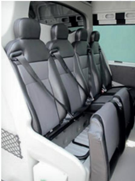
**Fixe** : 3 à 4 sièges individuels ergonomiques avec ceintures 3 points. Cloison totale, résistante et espace de rangement sous assise. Longueur utile de chargement préservée.
