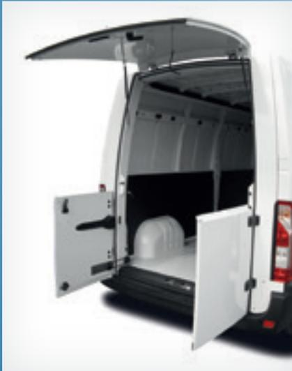
Remplacement des portes arrière par un hayon relevable et deux portillons
