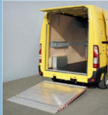
Face arrière avec hayon élévateur et portillon supérieur relevable
