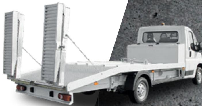
Plateau porteur avec rampe de chargement et coffre
