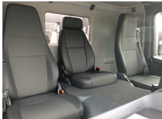
Cette innovation est notamment réalisable grâce à la mise en place d'un échappement central, rendu possible par la norme Euro 6, qui permet l'agrandissement de la cabine sans répercussions sur l'empattement.
