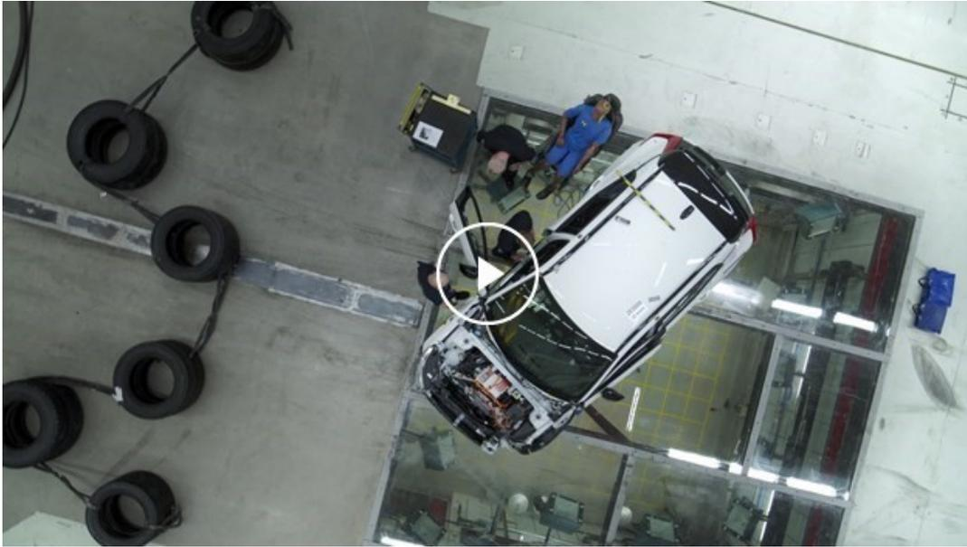
Le laboratoire contient deux pistes d'essai mesurant respectivement 108 et 154 mètres de long. La plus courte des deux pistes est mobile et peut être positionnée à un angle compris entre 0 et 90 degrés, permettant ainsi de réaliser un crash test selon des vitesses et des angles différents, ou de simuler une collision entre deux véhicules en mouvement. Dans le cadre des crash tests, les véhicules peuvent être lancés à des vitesses supérieures à 120 km/h.
