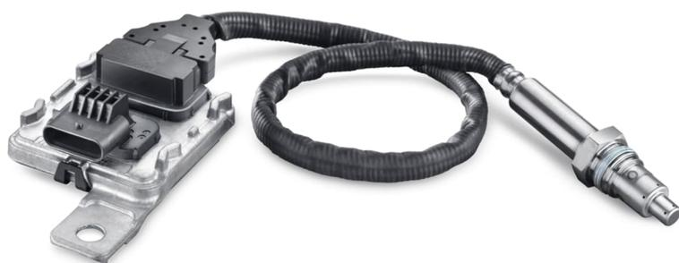
Le capteur NOx mesure de manière précise et continue la concentration d'oxydes d'azote dans les gaz d'échappement des véhicules diesel, contribuant ainsi à des émissions plus propres.
