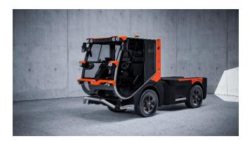
Jungo est l'une des premières entreprises à avoir lancé cette année sur le marché un véhicule multifonction doté de la technologie d'entraînement par moyeu de roue Schaeffler. Jungo et Schaeffler se sont associés pour adapter la technologie d'entraînement aux exigences quotidiennes spécifiques du balayage des rues.
