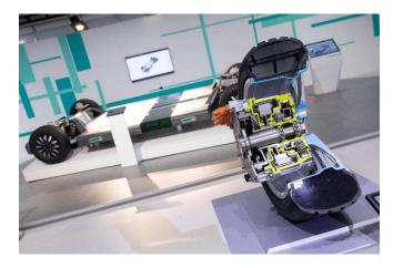
Tous les composants nécessaires à la propulsion et au freinage sont intégrés directement dans la jante de la roue, plutôt que d'être positionnés au centre ou montés sur les essieux moteurs. Cette
