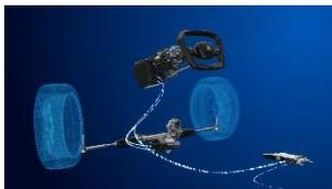
Avec son système Steer-by-Wire, ZF élimine toute liaison mécanique entre le volant et la crémaillère de direction.
