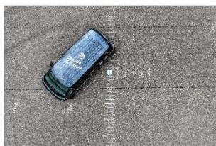
Avec EasyTurn, l'angle de braquage maximal des roues avant double, passant de 40 à 80 degrés – ce qui réduit le rayon de braquage d'une berline moyenne de plus de dix mètres à moins de sept.
