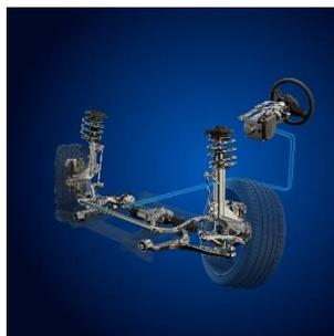
ZF EasyTurn : le système de suspension pour essieu avant qui offre un angle de braquage maximal.
