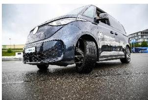
Maniable dans les espaces les plus restreints. EasyTurn permet un angle de braquage maximal de 80 degrés sur les roues avant. Une avancée majeure pour les citadines, les véhicules de livraison et les navettes opérant en milieu urbain.
