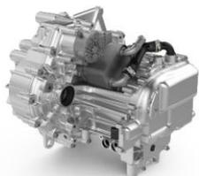
Le **eRE+** (Electric Range Extender plus) combine génération d'énergie et entraînement supplémentaire, grâce à l'expertise de ZF dans le domaine des systèmes de transmission.
