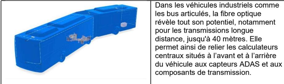
Dans les véhicules industriels comme les bus articulés, la fibre optique révèle tout son potentiel, notamment pour les transmissions longue distance, jusqu'à 40 mètres. Elle permet ainsi de relier les calculateurs centraux situés à l'avant et à l'arrière du véhicule aux capteurs ADAS et aux composants de transmission.
