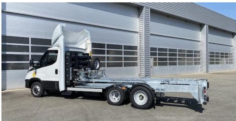
MAXICARGO est un concept innovant de remorque attelée à cheval sur le véhicule tracteur et guidée dans l'axe.
