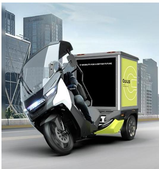
Le triporteur Gaius Rapide3 est motorisé par un système Valeo 48V eAccess. C'est une solution tout-en-un qui intègre le moteur 100% électrique (prenant pour base un alerno-démarrateur Valeo iBSG 48V ou integrated Belt Starter Generator) et le système de transmission dont le réducteur a été conçu en partenariat avec l'entreprise américaine Dana.
