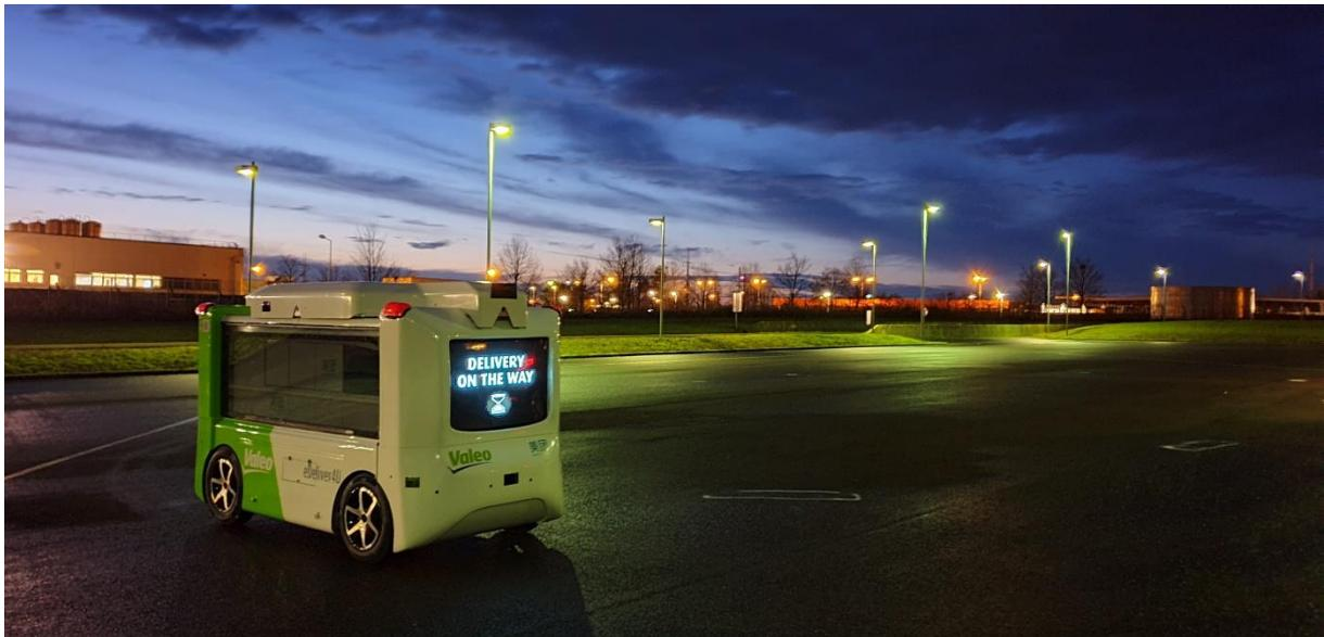
Valeo eDeliver4U rassemble les systèmes de visibilité, d'éclairage et de signalisation, 'Plug & Play', immédiatement prêts à l'usage. Leur mission est multiple : permettre aux capteurs d'être toujours opérationnels quelles que soient les conditions d'usage [voir les détails techniques ci-dessous] ; permettre au droïde de voir et d'être vu de tous et notamment des piétons ; assurer la communication au moyen d'écrans à résolution HD, avec les personnes interagissant avec lui.
