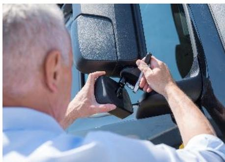
Le système RightViu de Continental est simple à installer car il se monte directement sous les rétroviseurs
