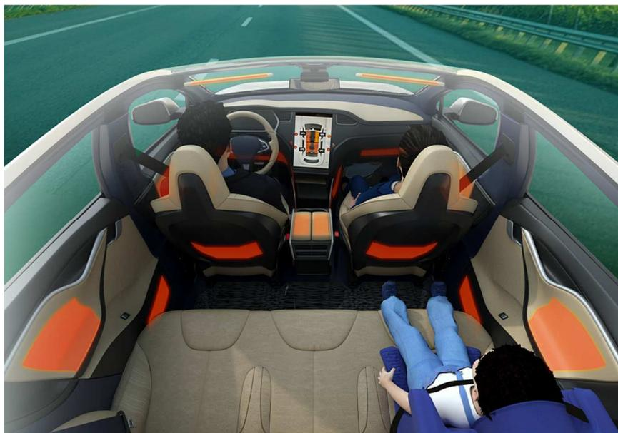
Elle dispense le meilleur confort aux occupants du véhicule de manière efficace. En effet, par rapport à un système de chauffage traditionnel qui délivre des flux d'air à la température souhaitée par ventilation, l'innovation de Valeo consomme un quart d'électricité en moins (avec 4 passagers dans le véhicule) et le gain va jusqu'à 50% quand le conducteur est seul à bord.
