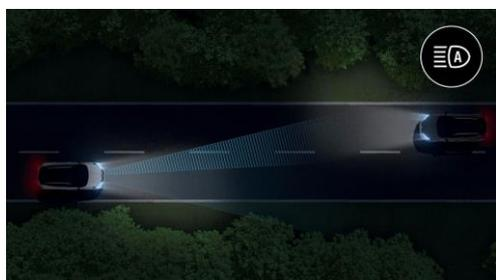
Utilisant la caméra frontale, le commutateur des projecteurs bascule automatiquement des feux de route aux feux de croisement selon la luminosité extérieure et la circulation, pour faciliter la conduite de nuit, y compris dans des conditions de luminosité très faible.
