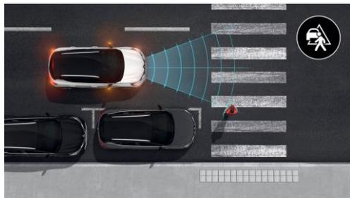
Déjà présent au sein de la gamme Renault sur Nouvelle Clio et sur Scénic, le freinage actif d'urgence avec détection de cyclistes et de piétons maximise la sécurité en alertant le conducteur d'une situation dangereuse et peut enclencher le freinage si celui-ci ne réagit pas. Il équipe Nouveau Captur de série sur toutes les versions et fonctionne de jour comme de nuit.
