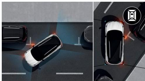
L'Easy Park Assist (aide au stationnement en créneau, épis ou bataille) facilite l'ensemble des manœuvres, tant pour se garer que pour sortir de sa place. Lors des manœuvres de stationnement, l'ensemble des capteurs gèrent la direction pendant que le conducteur n'a plus qu'à gérer les pédales et la boîte de vitesses.
