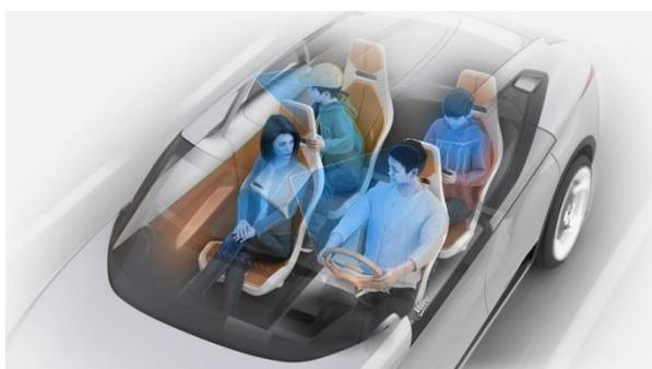
Valeo présente au salon du CES 2018 son dispositif de signalement de présence de personnes dans la voiture, quand le moteur est éteint. Grâce aux capteurs installés dans les habitacles, le système identifie le nombre de personnes, leur emplacement et leur morphologie. Le véhicule, doté de la technologie Valeo, active une alarme sonore et visuelle et transmet l'information sur *smartphone*, afin que plus personne ne soit oublié dans une voiture stationnée.
