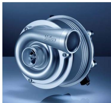
L'Electric Supercharger permet de réduire les consommations tout en conservant un plaisir de conduite. Le compresseur n'est plus entraîné par le flux des gaz d'échappement (comme c'est le cas pour le turbocompresseur) mais par un moteur électrique de technologie dite à « reluctance variable » au temps de réponse instantané (250 millisecondes).
