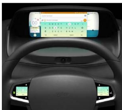
Lorsque le système détecte les conditions favorables à une phase de conduite automatisée, dans un embouteillage en ville ou sur autoroute par exemple, **Valeo Mobius™ 2 propose au conducteur de passer en conduite automatique** en appuyant sur le bouton « auto pilot » du volant. De la même façon, dès que le système anticipe la nécessité pour le conducteur de reprendre la main, il l'indique en amont au conducteur par un signal visuel et sonore.
