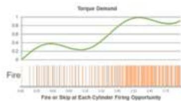
À chaque révolution du moteur, la DSF détermine l'activation des cylindres en temps réel.
