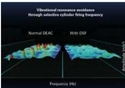
Le choix des cylindres à désactiver vise à éviter les modes de résonance directement à la source afin de garantir un niveau exceptionnel d'agrément de conduite.
