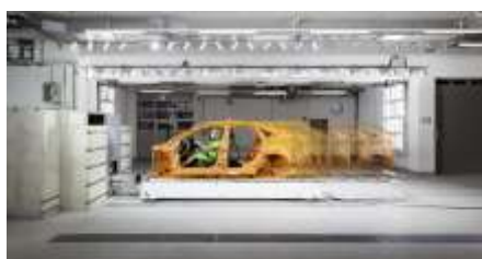
Le cœur du centre de compétences pour la sécurité est le nouveau banc d'essai destiné aux tests à traineau
