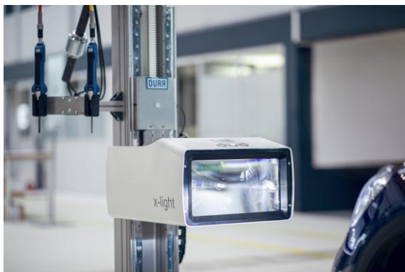
Photo 3 : Système de mesure et de réglage de phares par caméra x-light
