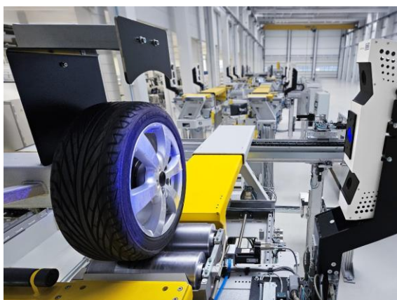
Photo 2 : Mesure et réglage ultraprécis du train de roulement à l'aide du capteur sans contact x-3Dsurface
