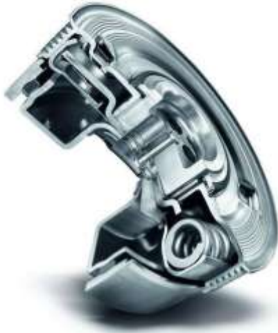
Photo 4: Coupe transversale du découpleur de poulie: le ressort en arc intégré réduit encore les vibrations de l'entraînement des accessoires.
