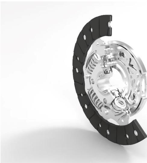
Légende photo : Le disque d'embrayage avec amortisseur de torsion et pendule centrifuge est une alternative économique au volant bimasse et élimine efficacement les vibrations de torsion dans la chaîne cinématique.
