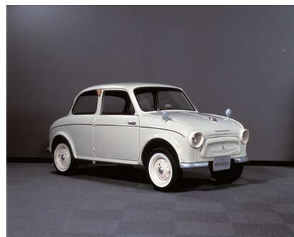
Elle possédait une conception pratique et simple, un moteur bicylindre deux temps à soupapes en tête / propulsion et des fonctionnalités de base telles qu'un essuie-glace, pas de clignotant, mais une flèche de direction installée sur le pilier latéral, etc.
