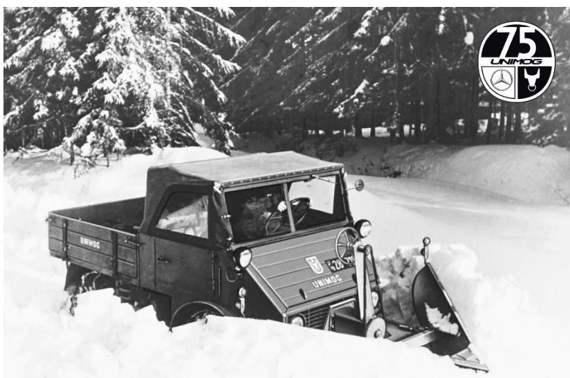
L'Unimog U 2010 de Mercedes-Benz avec une lame à neige K1. Le mécanisme de levage et d'abaissement mécanique du premier Unimog pour le déneigement était actionné par un volant à main situé à la base du capot.
