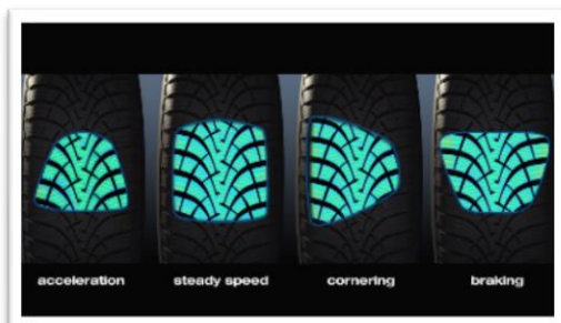
Profil avec lamelles et arêtes mordantes
