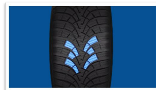
Variation de la géométrie des blocs
