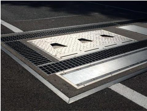
plaque mesure à la fois la hauteur de gomme et la pression de chaque pneumatique du véhicule lorsque celui-ci roule dessus. Ces informations sont transmises au serveur Goodyear et analysées par les algorithmes prédictifs. Un rapport complet est ensuite édité. Il prévient de toute anomalie comme une bande de roulement usée ou un sous-gonflage. Les algorithmes calculent également le kilométrage restant pour chaque pneumatique. Cela permet de
