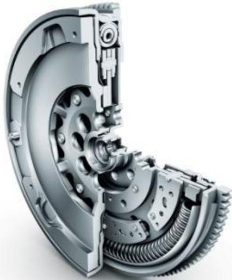
Légende photo : Volant bimasse à pendule centrifuge de Schaeffler
